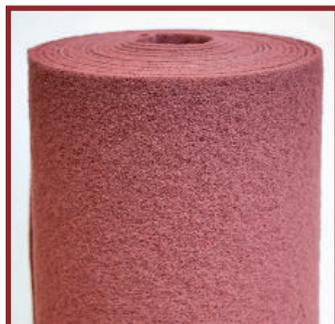
L'articolo 118 è un panno abrasivo in fibra sintetica a struttura aperta. E' indicato per la satinatura e pulitura dei metalli con ridotta asportazione di materiale. Resiste ottimamente all'acqua e ai lubrificanti.
